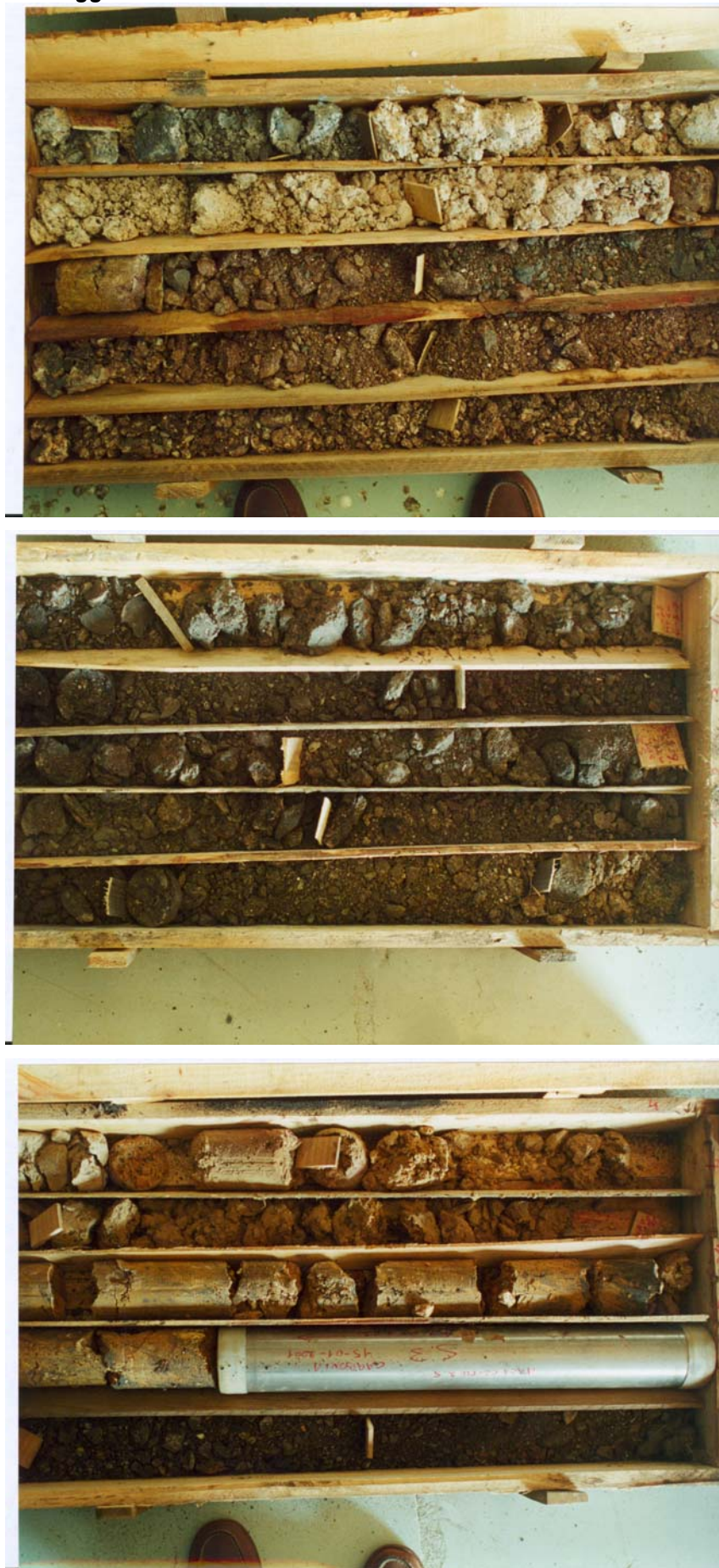
Foto della cassa e posizione del campione indisturbato prelevato
